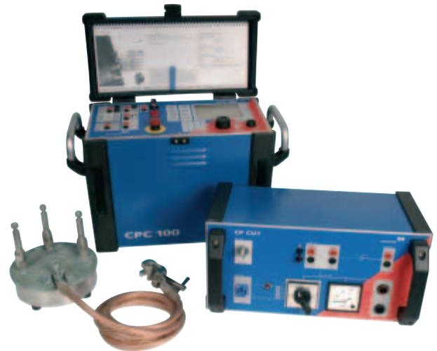
Sistema multifuncional de pruebas primarias CPC 100 en combinación con la unidad de acoplamiento CP CU1 y la caja de conexión a tierra CP GB1
